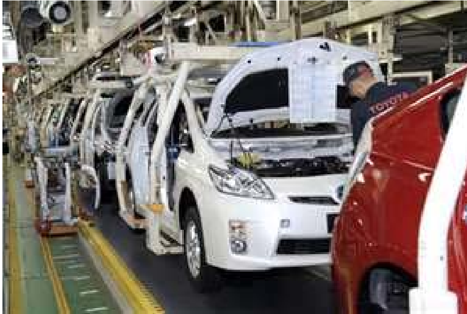
圖1-1汽車線型生產線組裝
