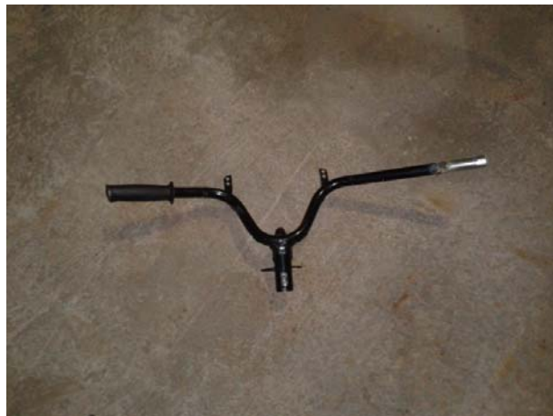
圖 8 我們將龍頭加長以方便安裝我們製作出的電磁式握把
