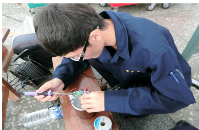
圖 19. 開關接點焊接
