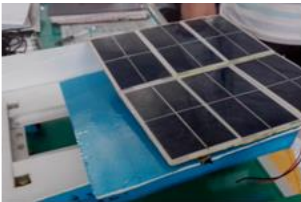
圖(6) 車頂加裝太陽能板
