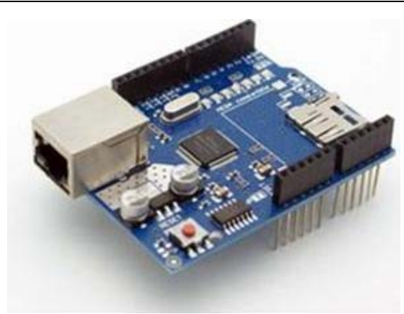
圖 11 Arduino Ethernet 網路+SD 卡擴展板
