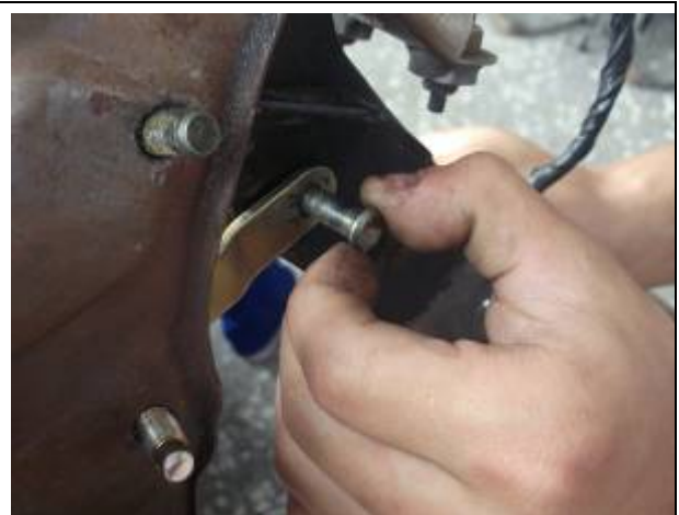
圖19 將倍力氣推桿及踏板插銷裝回
