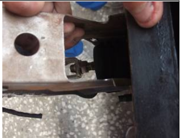
圖17 將煞車踏板和真空倍力氣組裝
