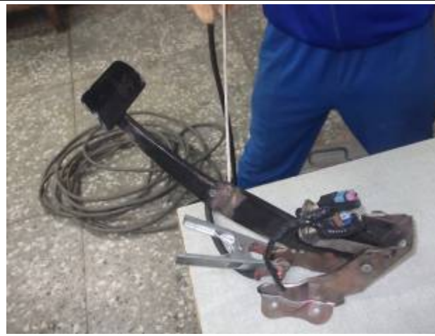
圖12 焊接踏板彎曲截斷部位焊接
