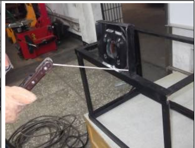
圖11 焊接真空被力器固定支架
