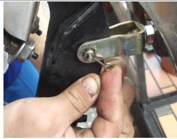
圖20 插入插銷後將固定銷插回
