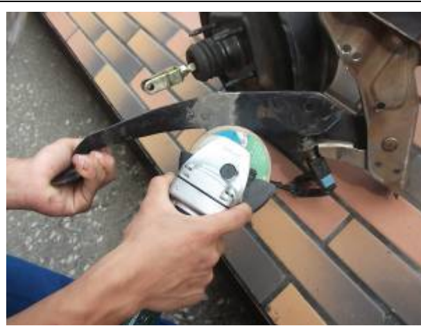
圖14 將焊接部位磨平後
