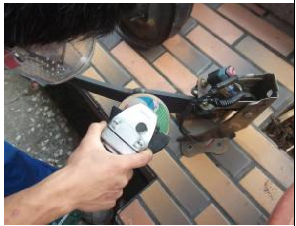
圖13 將焊接部位磨平
