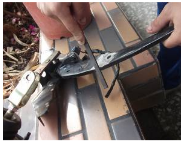
圖16 將磨平部分拋光完成
