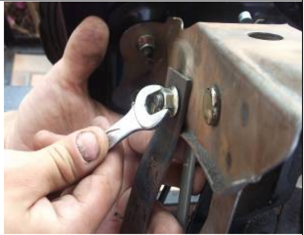
圖21 將腳踏式手煞車及煞車踏板固定並鎖上
