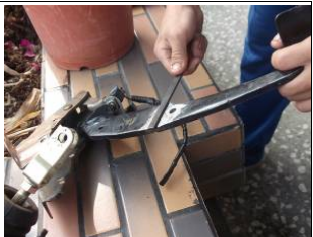
圖15 將磨平後部位用銼刀拋光
