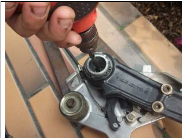
圖6 先將固定位置鑽出
