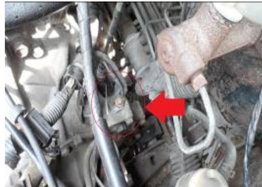
(圖 3-4)電瓶正負極鬆脫容易造成 搭鐵產生火花起火燃燒
