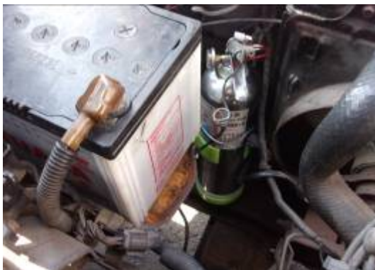
(圖4-4) 架設滅火器
