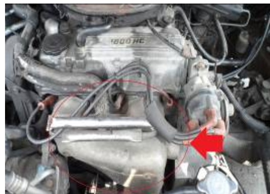
(圖 3-7) 排氣管高溫源與機油殼接近易起火燃燒
