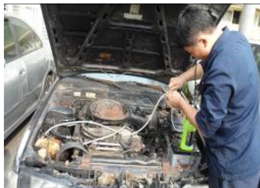
(圖4-9) 將管線長結合滅火器並牽管
