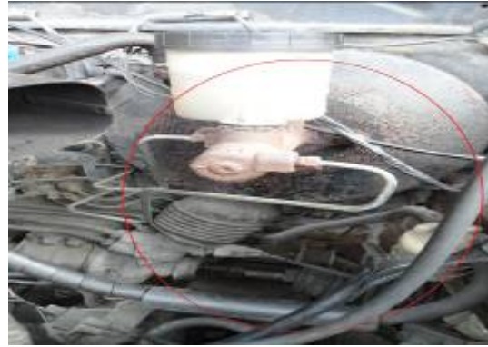
(圖 3-3)剎車油洩漏會與電瓶搭鐵起 火燃燒
