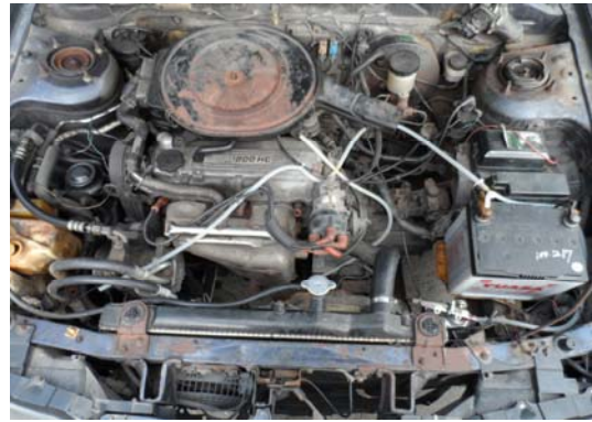
(圖4-13) 將管線導引至各起火點(四)
