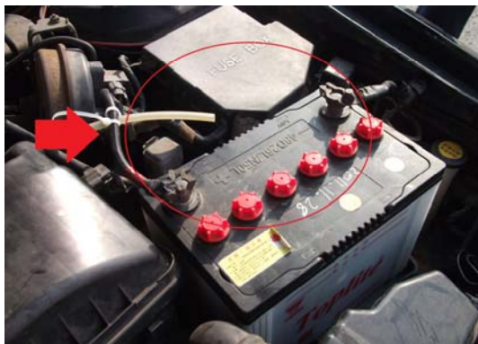
(圖3-16)將管路遷至電瓶端
