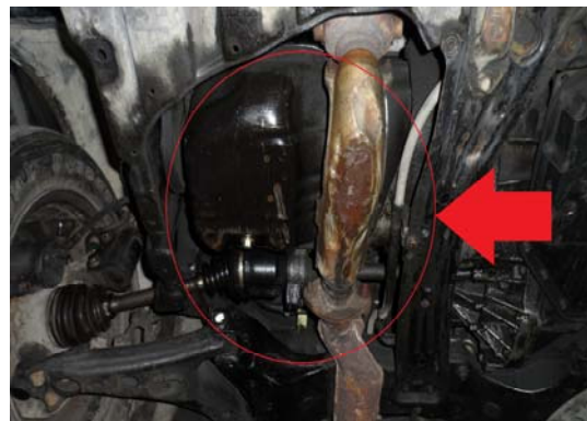
(圖 3-2)機油洩漏會與排氣管的高溫源造成起火燃燒
