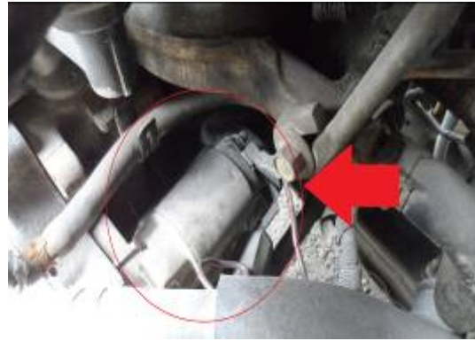
(圖 3-6) 啟動馬達電洩漏易造成起火燃燒
