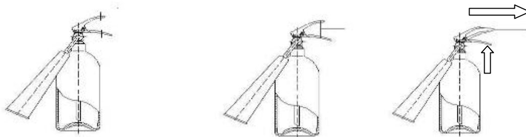
(1) 把滅火器固定引擎室內 (2) 將鋼線穿入把手 (3) 拉動鋼線使其作動
