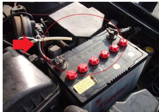
(圖 3-4)電瓶正負極鬆脫容易造成 搭鐵產生火花起火燃燒
