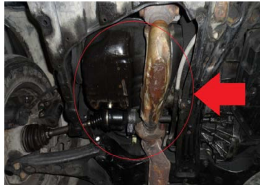
(圖 3-7) 排氣管高溫源與機油殼接近易起火燃燒
