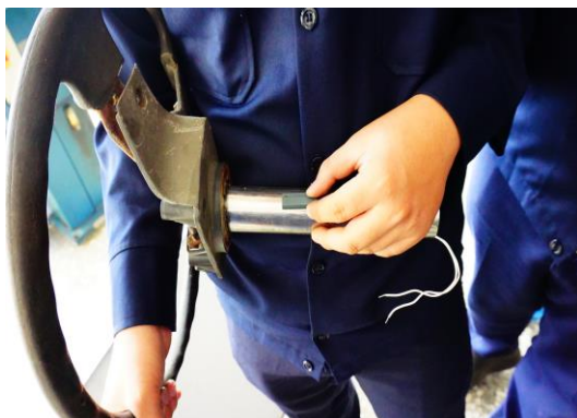
圖23為 轉向機柱安裝磁簧開關
