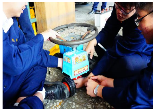
圖24為 裝好磁簧開關線路測試
