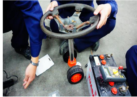
圖22為 模擬轉向機製作完成
