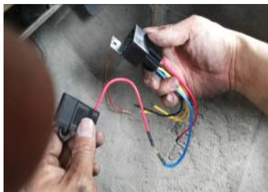
圖 1-3 外接噴油嘴保險絲座和繼電器開關
