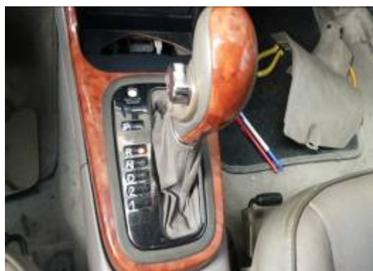
圖2-6 將檔位排至D或R檔進行測試
