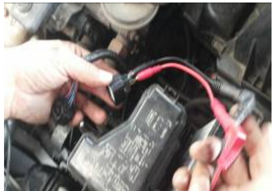
圖 1-2 安裝 P 檔和 N 檔外接線
