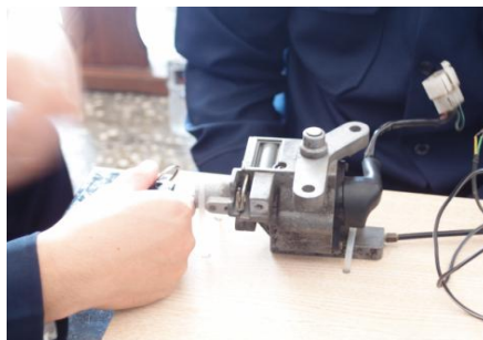
(圖 4-4) 鎖頭安裝作業
