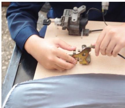
(圖 4-2) 椅墊鎖測試
