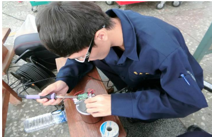
圖 19. 開關接點焊接
