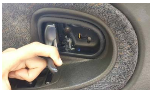
(圖 5) 紅外線改良之設計： 將紅外線做切割，發射器與接收器置於上和下，圖中藍點為發射器
