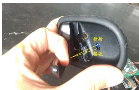
(圖 4) 紅外線原本之設計： 原本之設計，是將紅外線的發射器與接收器放在一起
