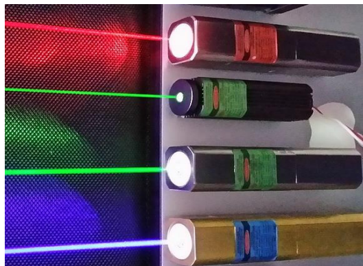
圖 3 雷射二極體發出可見雷射
