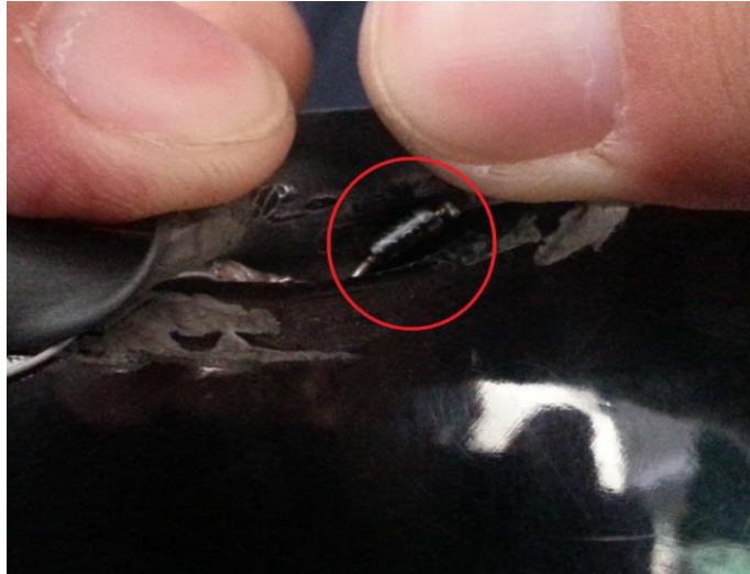
圖十二 串聯二極體 再串聯一個二極體防止逆電流
