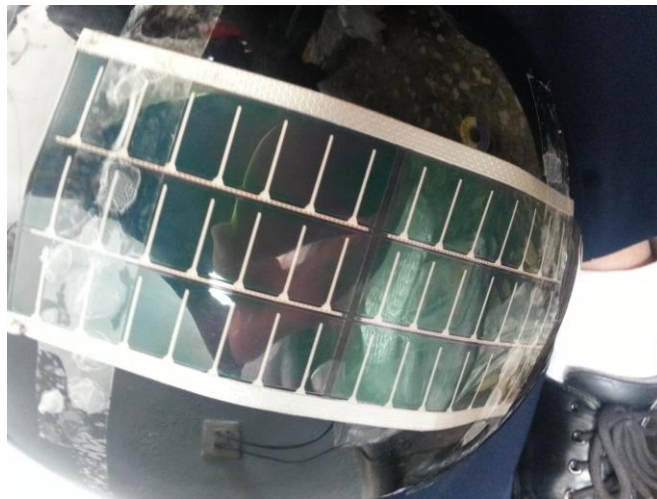
圖十三 黏貼太陽能板 最後將太陽能板貼在安全帽上，完成整個電路，以供整個裝置正常作動
