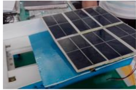
圖(6) 車頂加裝太陽能板
