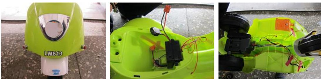
圖4-4為 裝置前方向燈 圖4-5為 裝置電瓶 圖4-6為 完成方向燈線路
