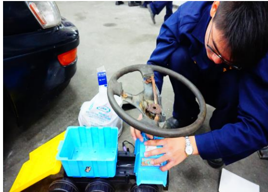
圖25為 裝置方向盤並將組裝於模型車上
