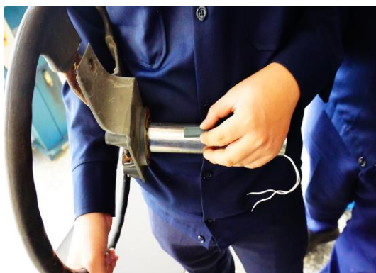
圖23為 轉向機柱安裝磁簧開關
