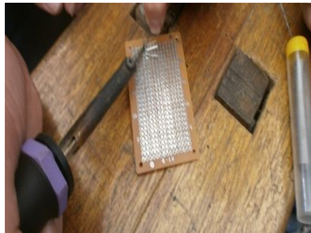
(圖 7) 銲接電路板
