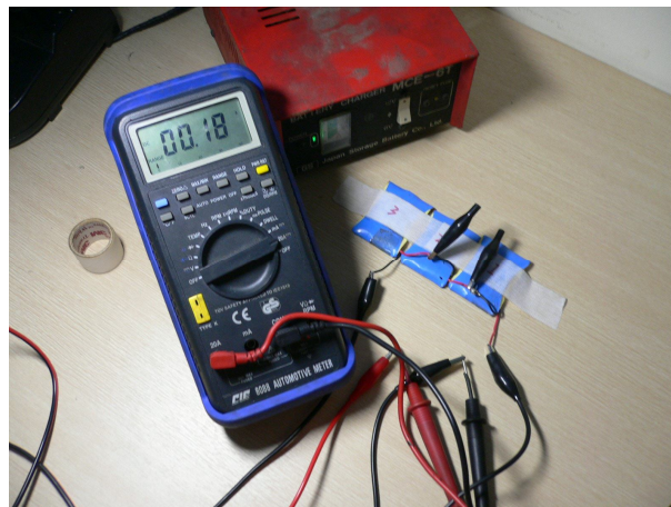
圖 3-1 單一電源對整個電池組充電( 自行拍攝 )
