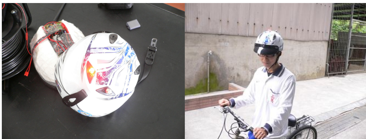
圖 4-2 腳踏車方向燈安全帽成品
