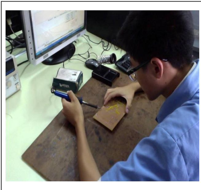
圖 3-1-2 焊接電路
