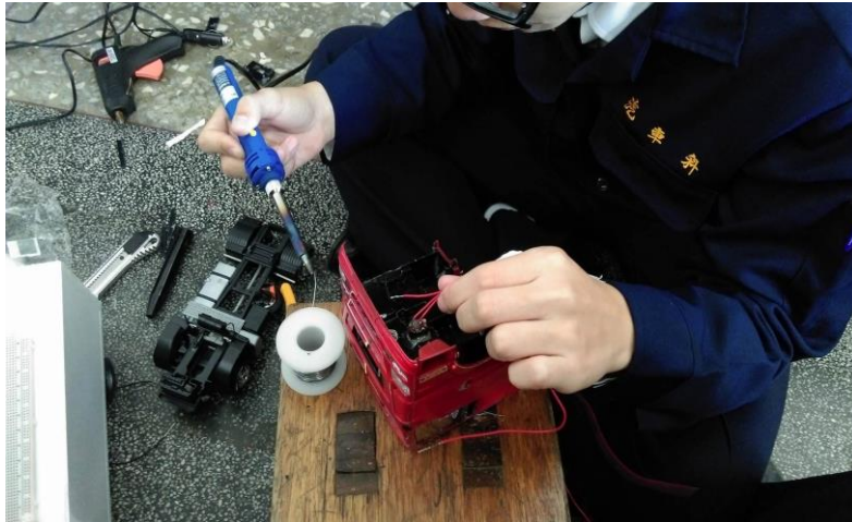
(圖 20)將線路焊接至模型上 (資料來源：自行拍攝)
