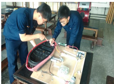
(圖4-7) 微動開關配線作業
