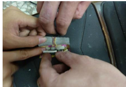
(圖4-6) 微動開關安裝作業
