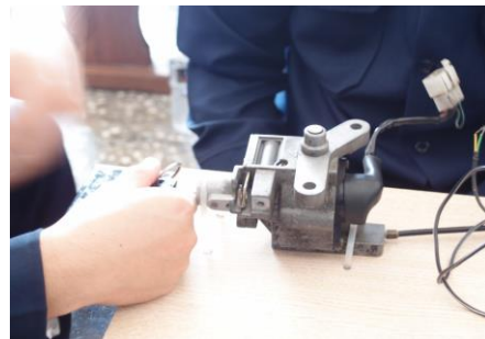
(圖 4-4) 鎖頭安裝作業
