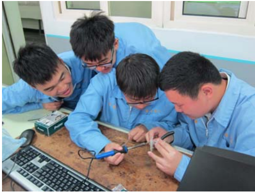
圖4-1-1 光立方體電路板製作過程(一)
