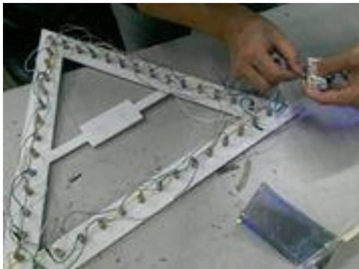
圖十 在三角板上裝置 led 燈具 (資料來源:自行拍攝)
