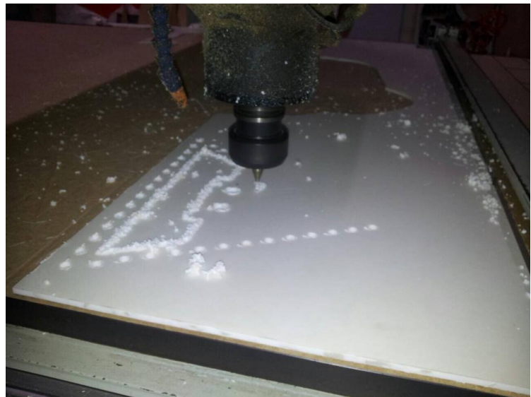
圖九 三角板中間鑽孔 (資料來源:自行拍攝)
