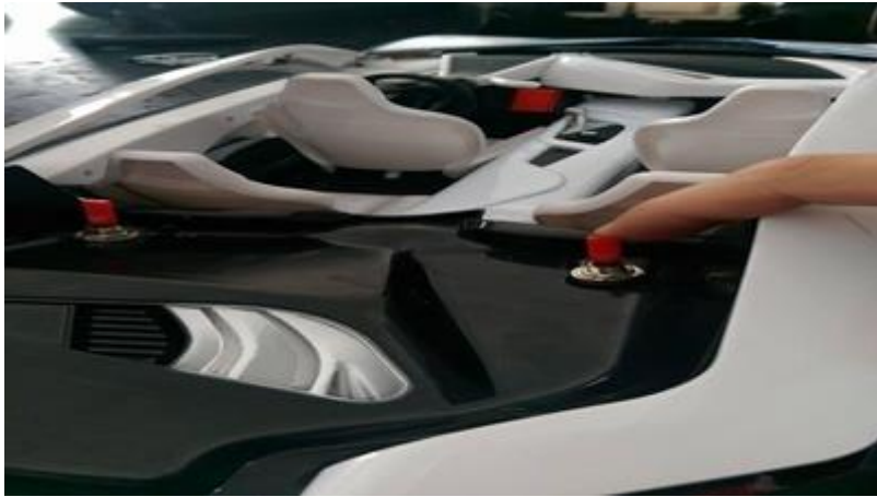
圖十六 將開關設置在車殼中 資料來源：(自行拍攝)
