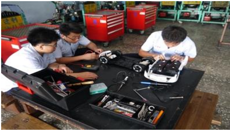
圖十九 將電路板配線於車身內 資料來源：(自行拍攝)
