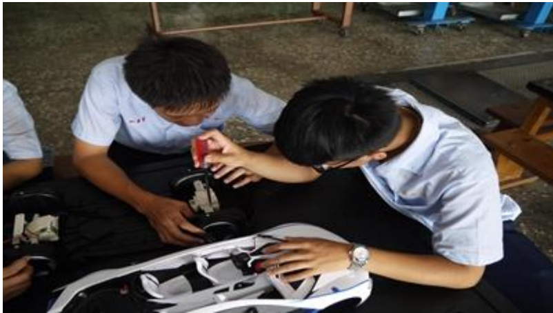
圖十七 將電路設置在模型車內 資料來源：(自行拍攝)
