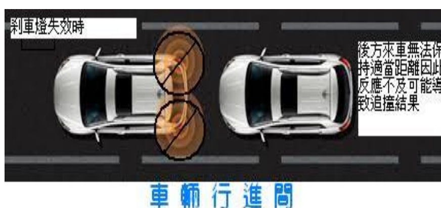
圖一 剎車燈失效示意圖
