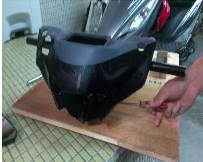
圖3.5：將龍頭外殼鎖緊 ( 資料來源：自行拍攝 )
