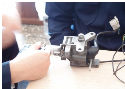
(圖 4-4)鎖頭安裝作業
