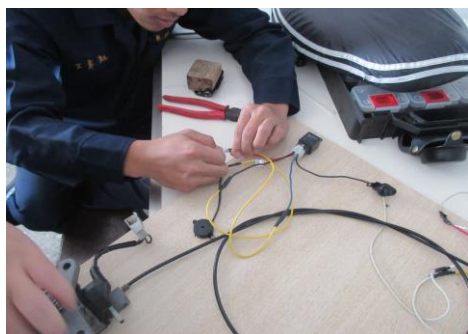
(圖4-7)感應器傳輸蜂鳴器配線作業
