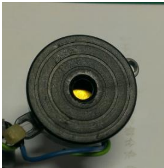
圖 10 壓電式蜂鳴器
