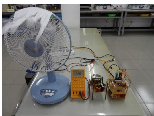
圖 24 左側發射端電位計滿刻度之四分之二時，右側是無線接收端之主電路的運作情形，交流輸出電壓 90V。
