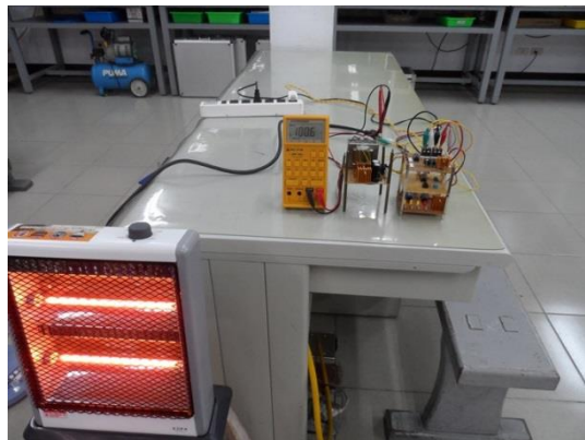
圖 27 左側發射端電位計 0V 時，右側是無線接收端之主電路的運作情形，交流輸出電壓 100.6V。
