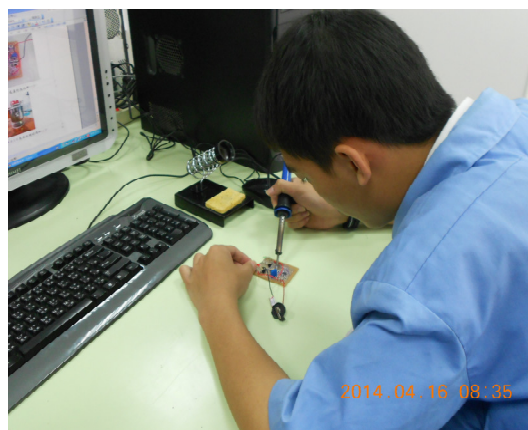
圖 4-1-2 感溫杯焊接過程(一)
