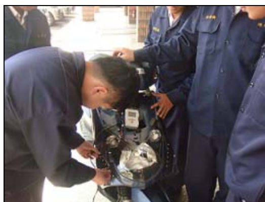
圖24. 裝置機車智慧型尋車及警示系統線組於機車上
