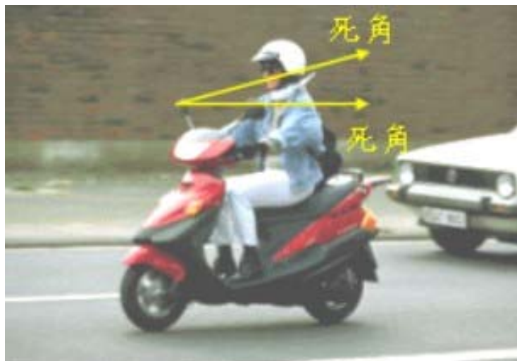
圖5 機車後照鏡的死角
