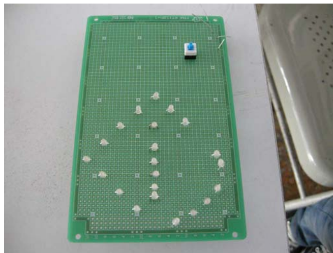
圖21焊接LED警示圖形
