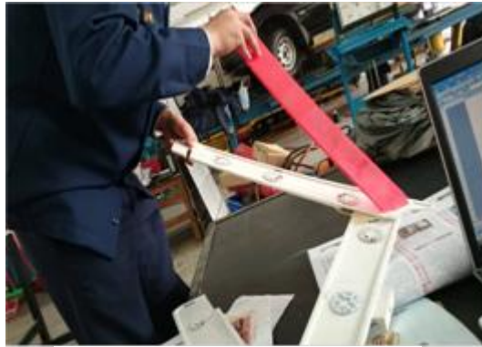
圖 8 將反光片裝上三角板
