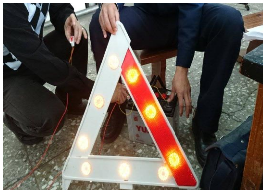
圖 9 測試裝上反光片後的效果
