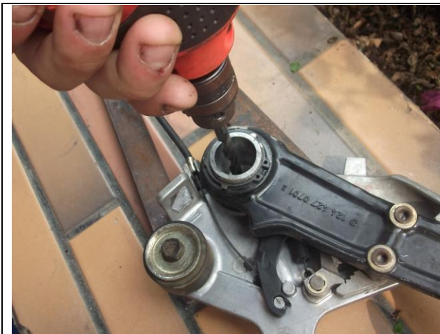
圖6 先將固定位置鑽出
