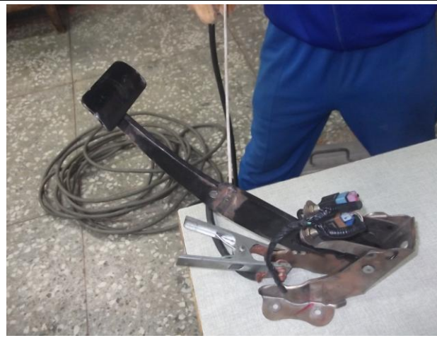
圖12 焊接踏板彎曲截斷部位焊接
