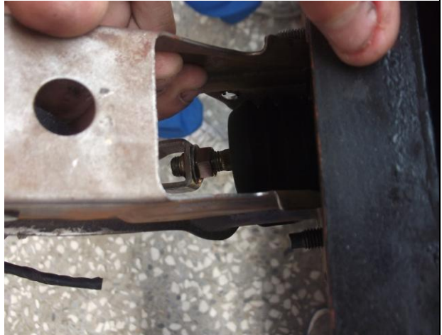
圖17 將煞車踏板和真空倍力氣組裝
