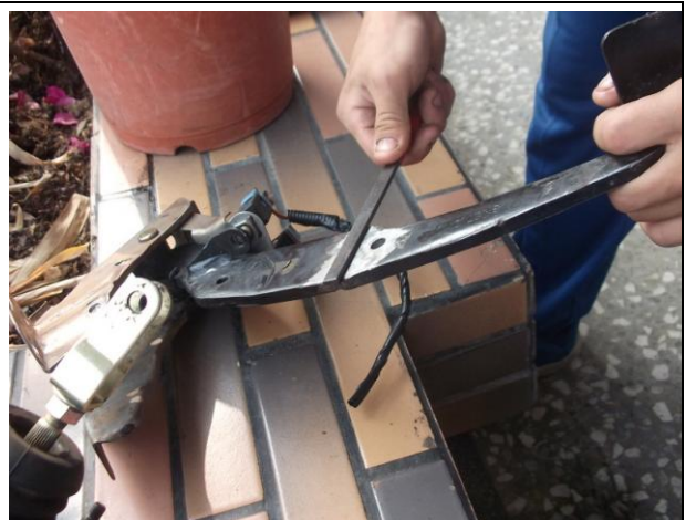
圖15 將磨平後部位用銼刀拋光
