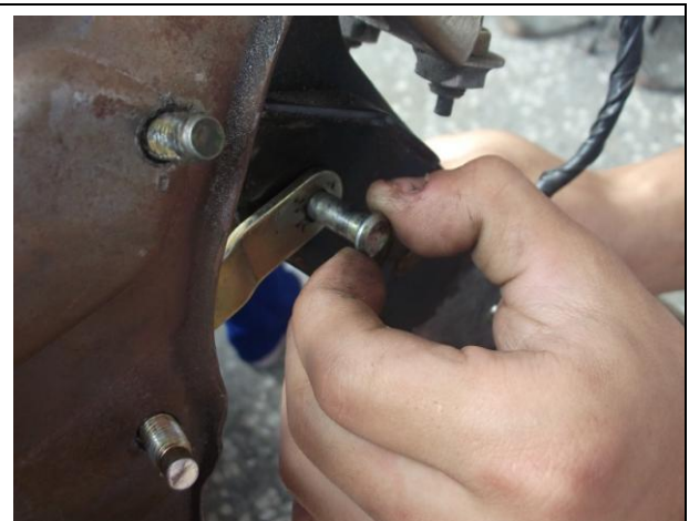
圖19 將倍力氣推桿及踏板插銷裝回
