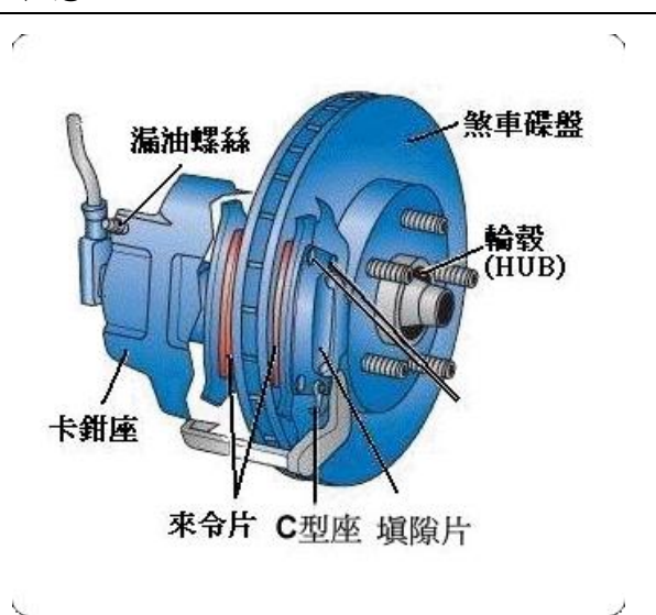
圖5 碟式煞車分泵解剖圖
