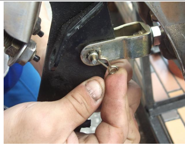
圖20 插入插銷後將固定銷插回
