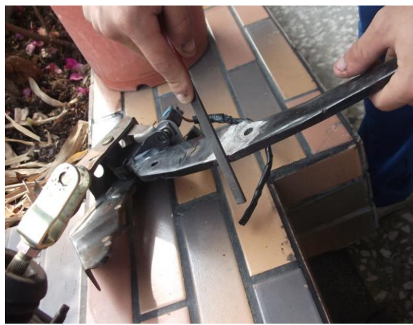
圖16 將磨平部分拋光完成
