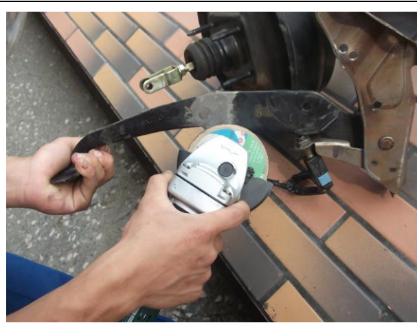
圖14 將焊接部位磨平後
