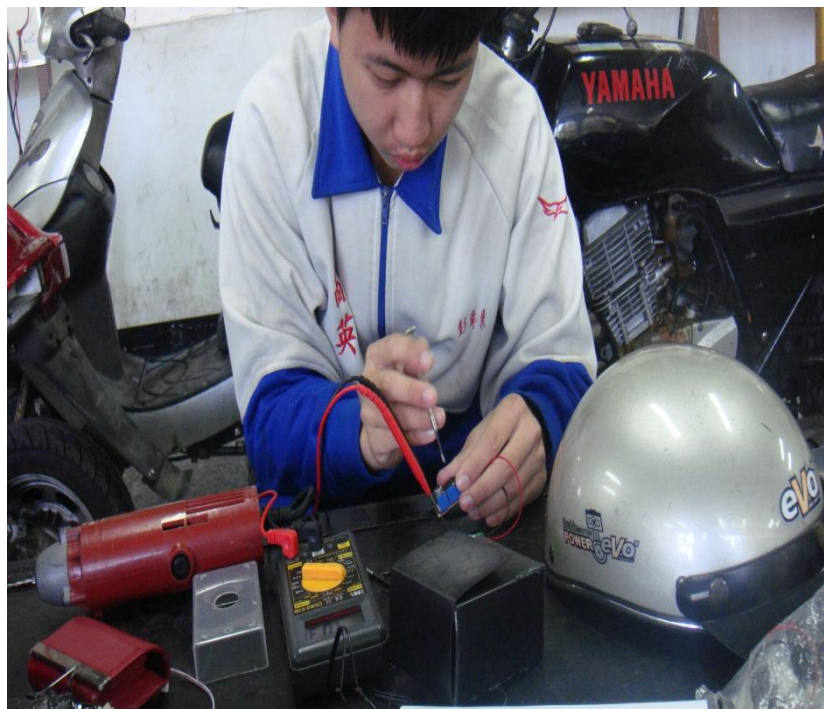
圖 10 充電模組量測電壓
