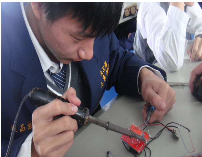
圖9 光敏繼電器模組焊接製作(二)
