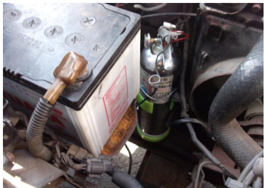
(圖4-4) 架設滅火器
