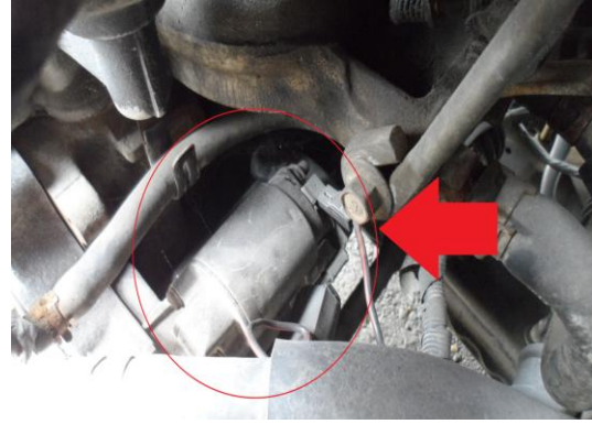
(圖 3-6) 啟動馬達電洩漏易造成起火燃燒
