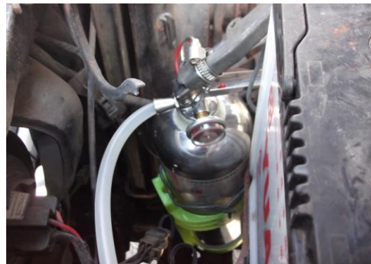
(圖4-15) 檢測滅火器是否能作用
