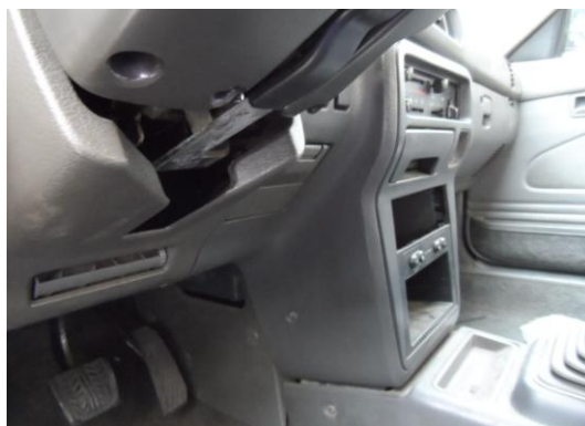
(圖4-6) 架設滅火器鋼索到車內拉柄
