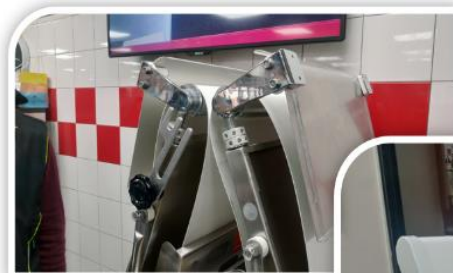
壓麵機加裝防捲夾防護裝置
