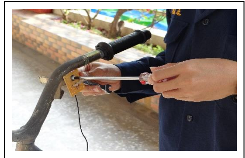
圖 4-16：感知器指示燈號安裝
