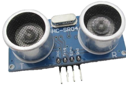
圖 3-5：超音波感知器
