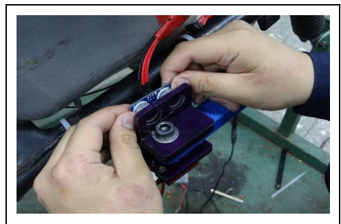
圖 4-14：超音感知器安裝
