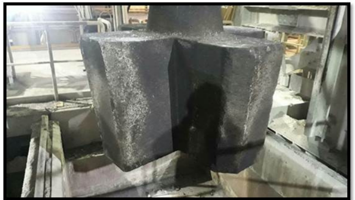
(圖八) 工程實績(煉鋼廠設備)-攪拌器耐材硬化模具拆除後狀況
