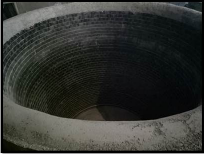
(圖十一) 工程實績(煉鋼廠設備)-煉鋼廠盛鋼桶砌磚作業
