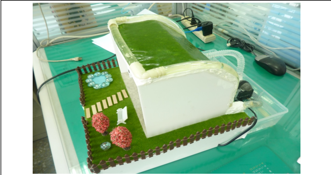
當溫度過高時，屋頂會自動灑水，利用水來降低房屋的溫度
