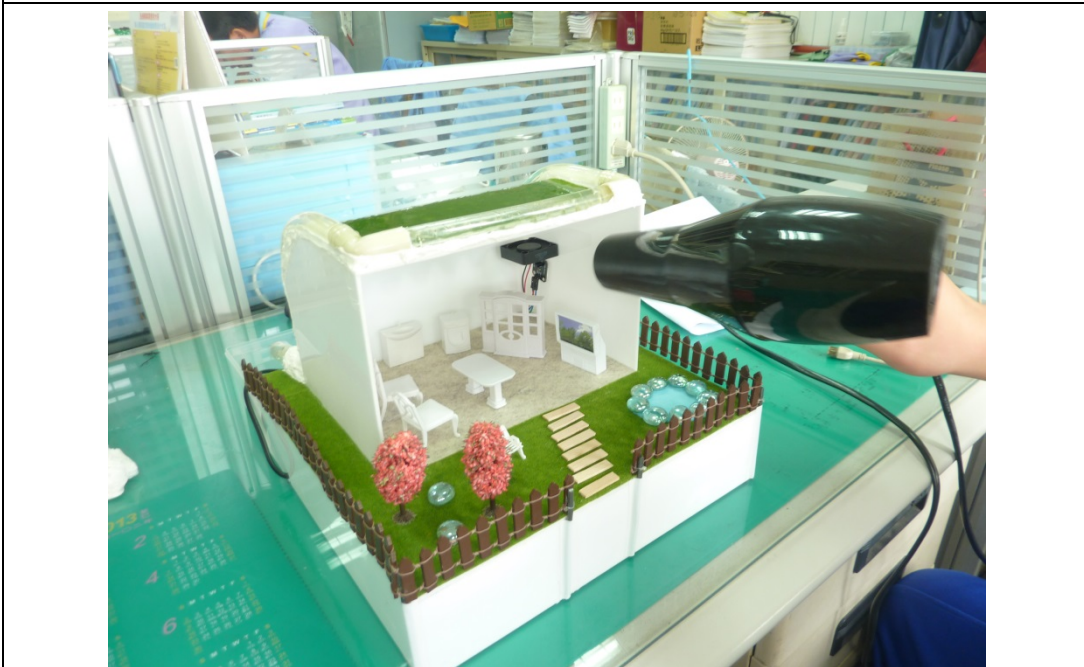
當屋內溫度過高，風扇會自動開啟，做到空氣流通的效果，使屋內溫度降低
