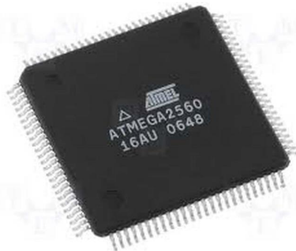
(圖 19 Atmega2560 IC 圖)
