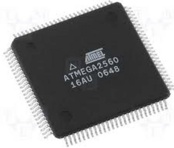
(圖 8 Atmega2560 IC 圖)
