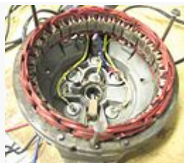
拆卸汽車交流發電機，顯示六個組成一個全波三相橋式整流二極體。
