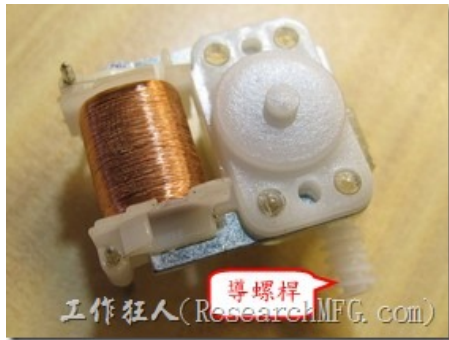
圖 2 機械式定時器導螺感圖(側面) 圖 3 機械式定時器導螺感圖(正面)
