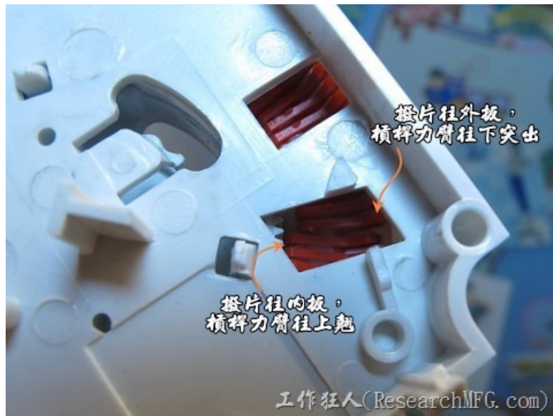
圖 6 機械式定時器內部構造之 3
