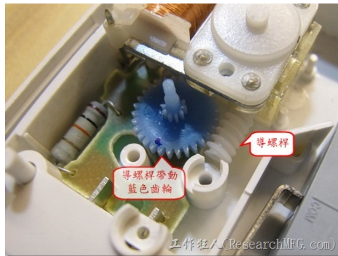
圖 2 機械式定時器導螺感圖(側面) 圖 3 機械式定時器導螺感圖(正面)
