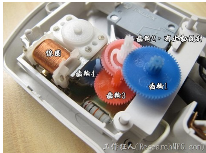
圖 5 機械式定時器內部構造之 2
