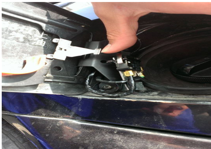
圖 7 微動開關測試 將開關按壓切換測試線路是否正常
