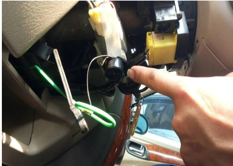
圖 1 點火線圈蜂鳴器安裝圖 安裝使油箱蓋未蓋時會發出聲響
