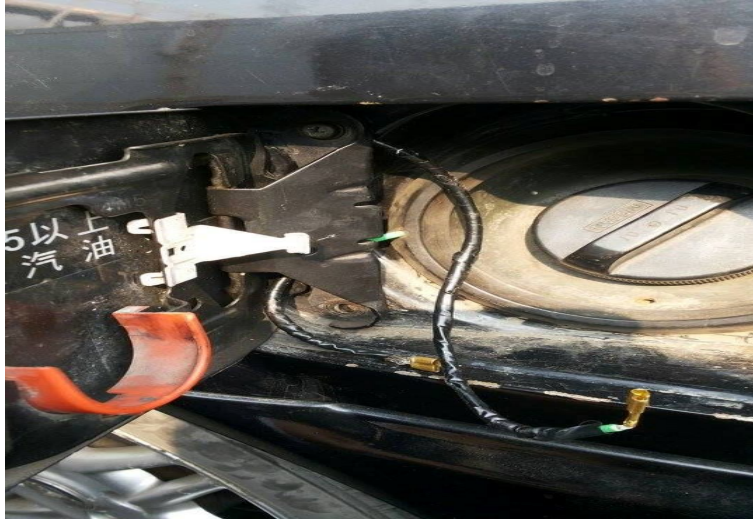
圖 5 包覆線圈!使接頭緊密 用膠布包覆線圈，並黏緊接頭
