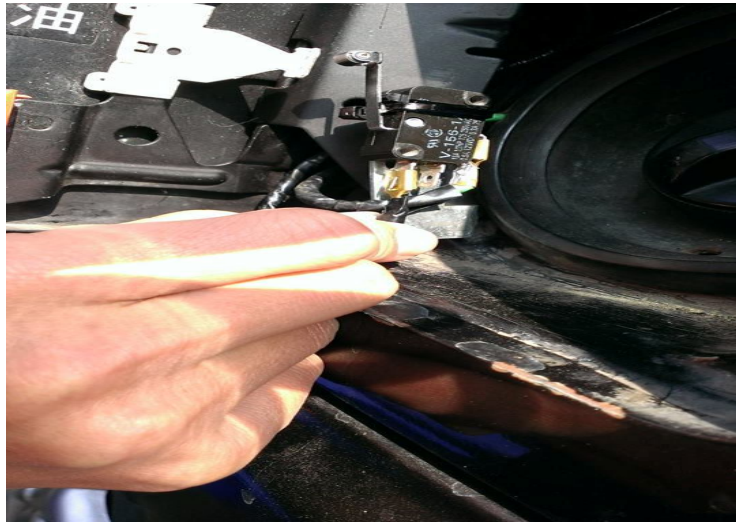
圖 8-2 微動開關線路接置 將接好的線路裝上開關測試
