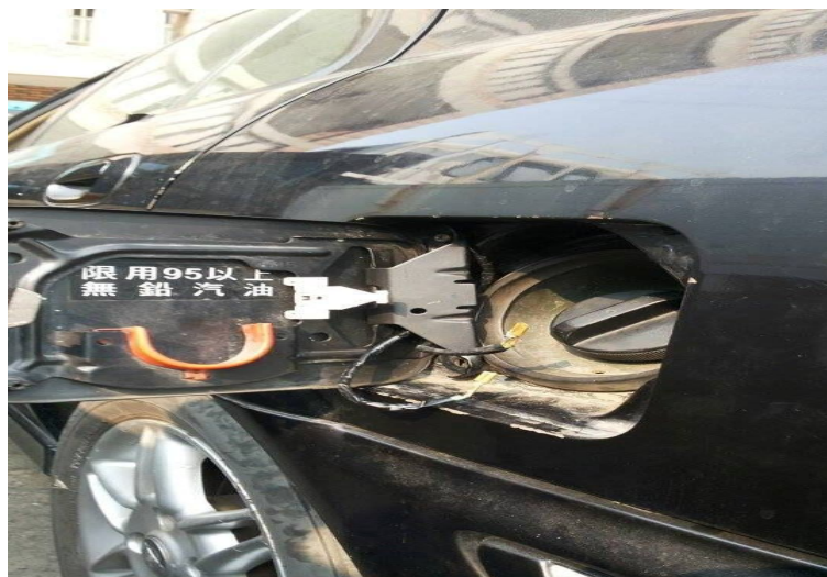
圖 4 蜂鳴器配線至油箱蓋內 將線路連牽至油箱蓋內，微做調整
