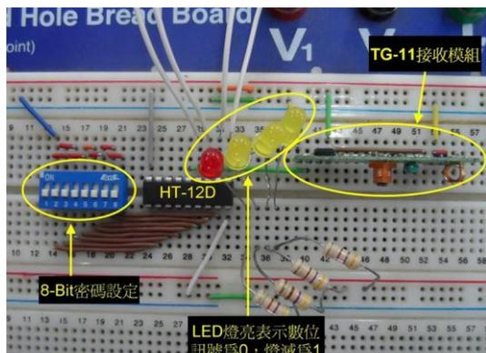
圖 18 無線接收電路(左側指撥開關用於設定密碼, LED 指示接收到之數位信號)
