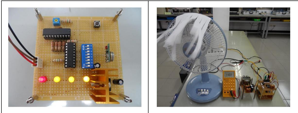
圖 24 左側發射端電位計 0V 時，右側是無線接收端之主電路的運作情形，交流輸出電壓 110.3V。
