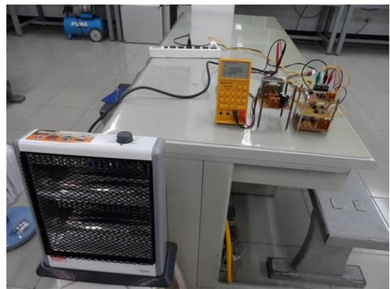
圖 29 左側發射端電位計滿刻度時，右側是無線接收端之主電路的運作情形，交流輸出電壓 0V。
