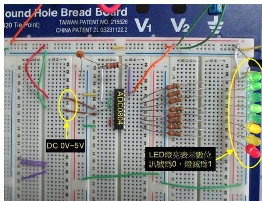
圖 16 類比數位轉換電路(以ADC0804為核心，8個LED指示8-Bit輸出信號)
