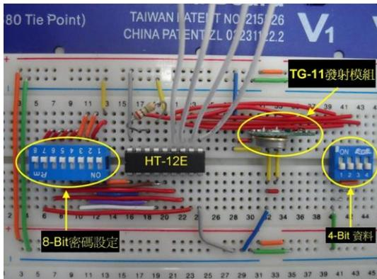
圖 15 無線發射電路（左側指撥開關用於設定密碼，右側指撥開關用於設定供測試之數位信號）
