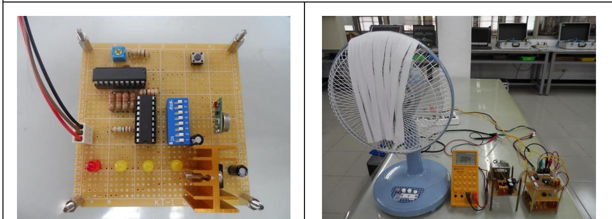
圖 26 左側發射端電位計滿刻度時，右側是無線接收端之主電路的運作情形，交流輸出電壓 0V。
