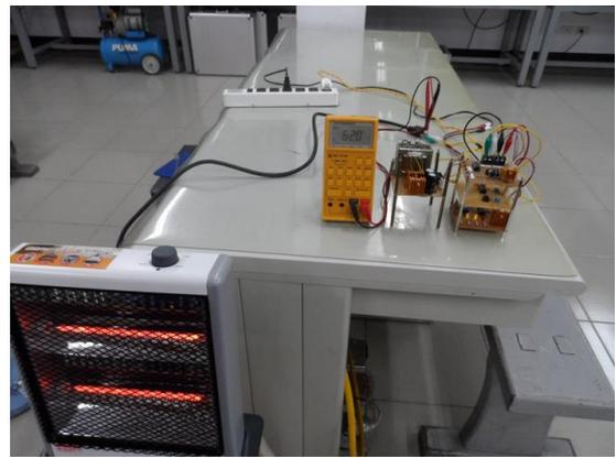
圖 28 左側發射端電位計滿刻度之四分之三時，右側是無線接收端之主電路的運作情形，交流輸出電壓 62V
