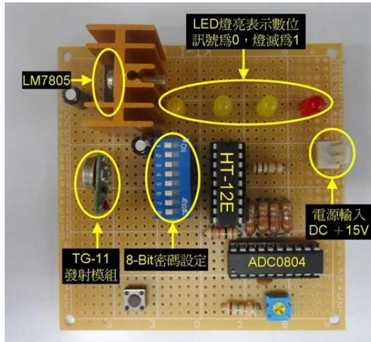
圖 17 無線發射電路及類比數位轉換電路實現於一塊萬用板
