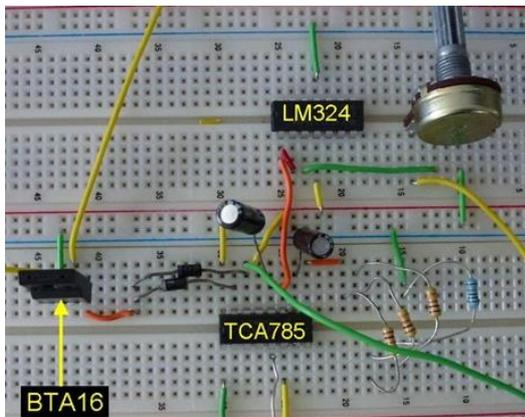
圖 22 相位控制電路實現於麵包板
