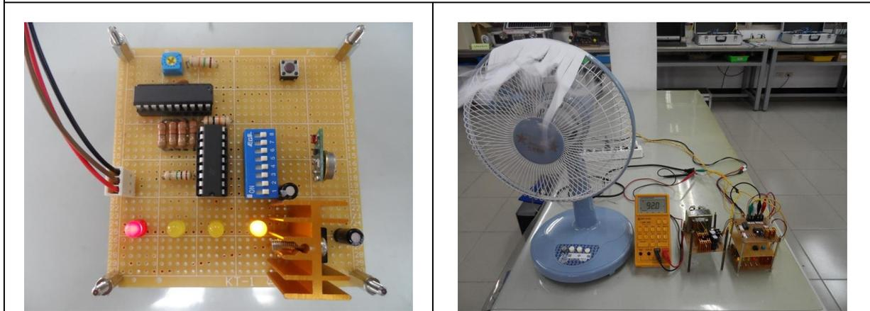
圖 25 左側發射端電位計滿刻度之四分之二時，右側是無線接收端之主電路的運作情形，交流輸出電壓 90V。
