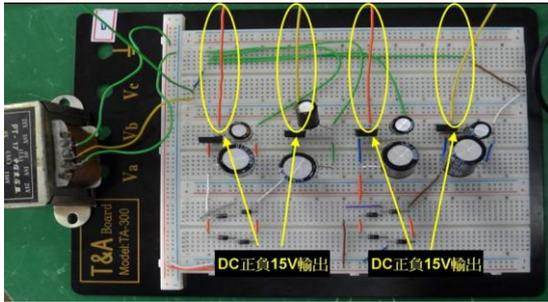
圖 13 整流電路實現於麵包板
