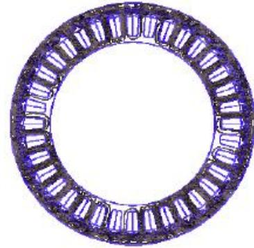
圖 7 螺旋轉子及定子電樞圖
