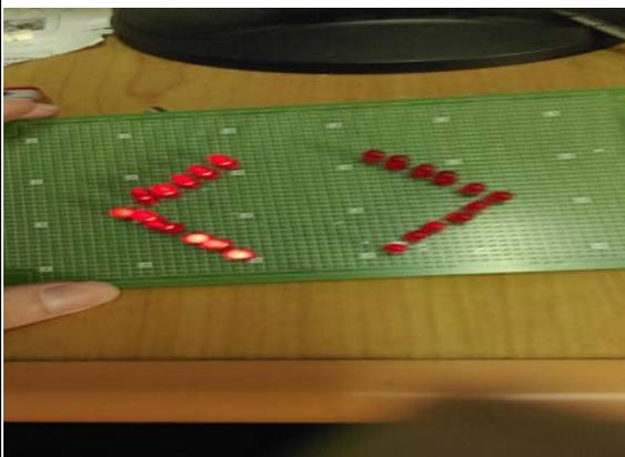
圖 10 電路測試左閃方向燈
