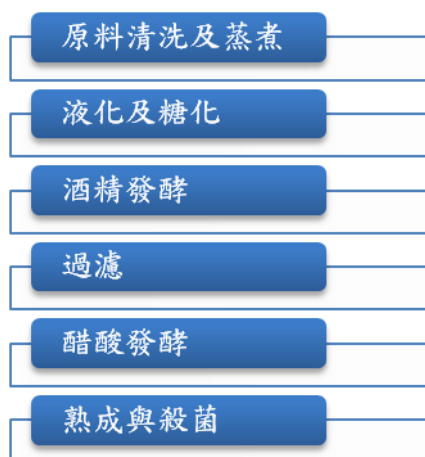
圖 1.釀造醋的製造過程
